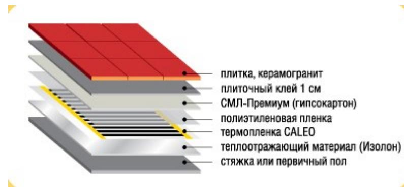
Схема монтажа теплого пола CALEO под плитку/керамогранит.
