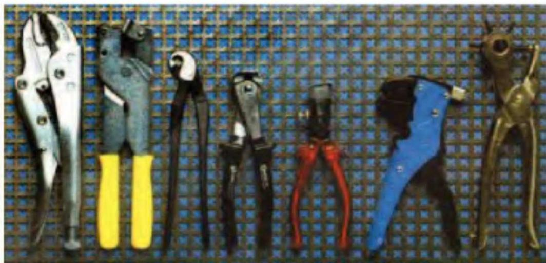
**Рис. 2.** Комплект специальных клемши (слева направо): зажимные щипцы, клемши для работ с плиткой, дыропробивные клемши для плитки, кусачки, клемши для удаления изоляции и дыропробивные клемши-револьвер.
